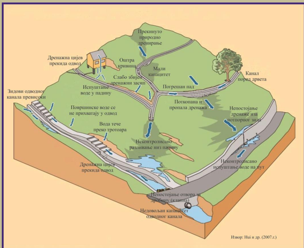
Слика 6: Лоше израђена дренажа, као фактор нестабилности падине
